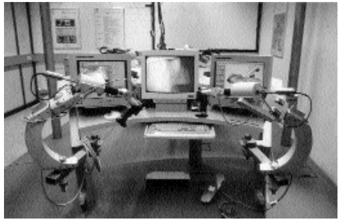
Fig. 4: La console del chirurgo con due bracci master per guidare le unità operative.
