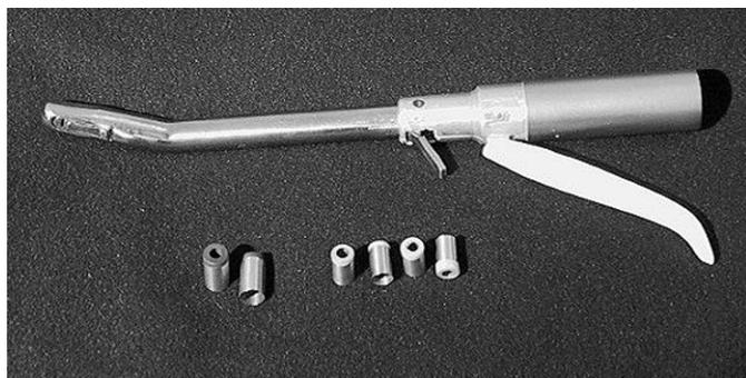
Fig. 1: Primo prototipo del grasping tie.
